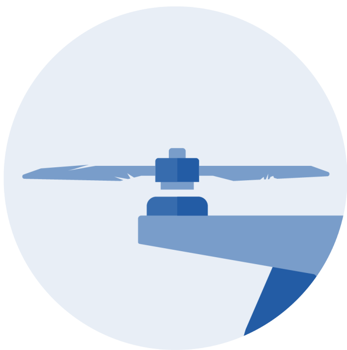
Figur 24 Propeller med sprickor
