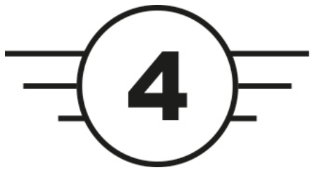
Figur 6 Så här ser märkningen ut på en C4-drönare
